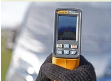
Die Infrarot-Technologie zeigt verbleibende Wärmebrücken auf.
