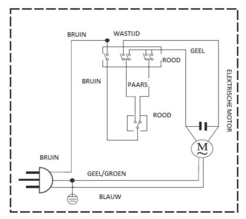
ACHTUNG: Wenn Sie den Motor überprüfen oder reparieren möchten, müssen Sie das 220-V-Kabel entfernen. Für die korrekte Verkabelung können Sie dem obenstehenden Schaltplan folgen.
